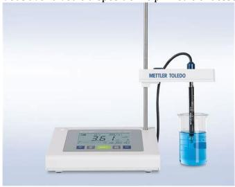
D'autres solutions et matériels sont disponibles au laboratoire à savoir : une pissette d'eau distillée, une pissette d'alcool, des essuie-mains, du papier de type « KimWippes », des solutions d'étalonnage pH4.0, pH7.0 et pH10.0, des béchers de 50 mL, de l'eau distillée stérile, de l'HCl, de la soude, 1 solution X de pH inconnue, du papier pH et des barreaux aimantés. L'électrode du pH mètre est dans sa solution de stockage.
