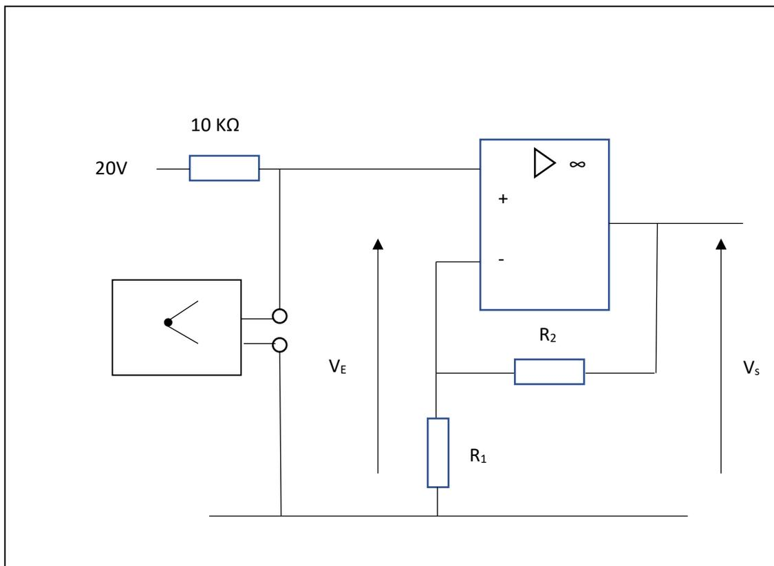
Dans ce montage la tension aux bornes du capteur de température est de 7,5V à 20°C et cette tension diminue de 2mV par °C.
