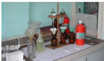
Filtres et bromoforme sous hotte
